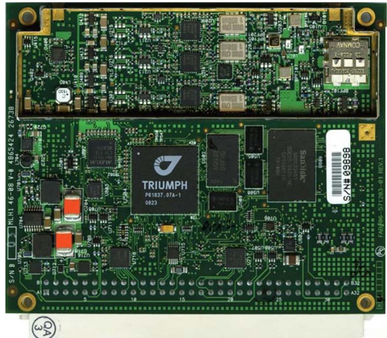
В плату TRE-G3TAJ встроена не просто шина CAN (Controller Area Network), а полноценный CAN-интерфейс с необходимой для его работы программно-аппаратной поддержкой. То же самое можно сказать и про порты RS-232/RS422.
